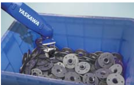
ビン衝突を回避する高速の 経路プランニング
